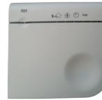
**RH sensor** sensor für das Belüftungssystem. Das Gerät kommuniziert Informationen über den Systemstatus über die funkgesteuerten Kommunikationsbereiche mit dem zentralen Steuergerät. Batteriebetrieben.
