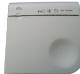
**CO<sub>2</sub> sensor** für das Belüftungssystem. Das Gerät teilt Informationen über den Systemstatus über die funkgesteuerten Kommunikationsbereiche mit dem zentralen Steuergerät mit.
