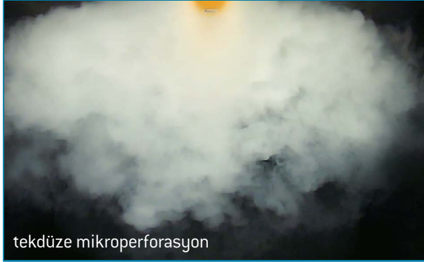
PRIHODA Ar-Ge merkezlerinde duman testi ile oluşturulan hava dağılımı uniform microperforation
